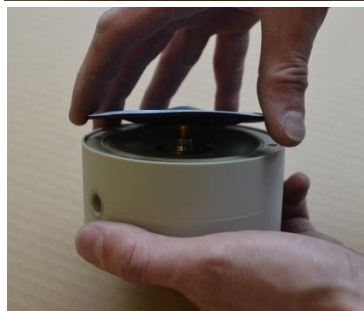
图 3.5.8 将隔膜片 [15] 从气阀 [61] 上拧下。
