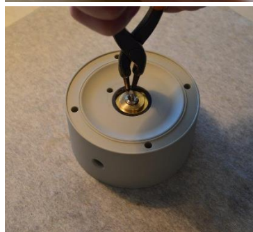
图 3.5.9 用钳子将两个卡簧 [27] 从中间体上 [12] 拆下。 注意！ 操作该步骤时，由于卡簧容易翻转，因此请用另一只手遮挡一下。
