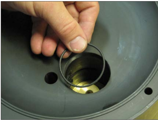
图5. 将一个o形环(pos 30)放在阀盖上。
