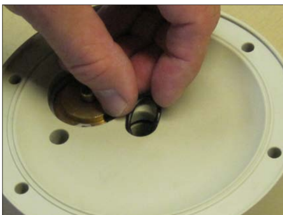
图9. 在槽内插入轴密封o形环(47)。
