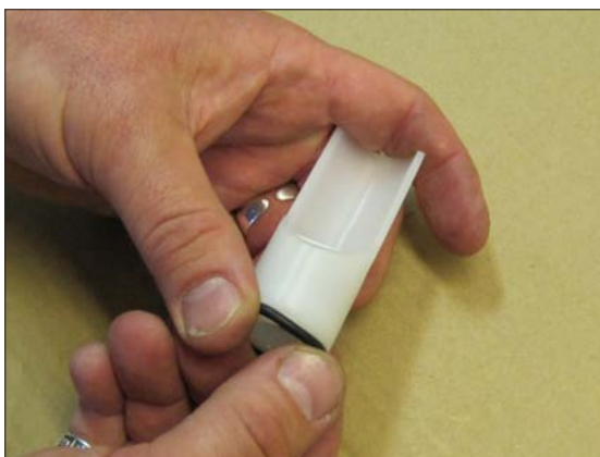
图13. 把阀球(23)放在低位阀座(21)和安装球挡(22)。 在阀座底部(21)安装阀座O形环(43)。
