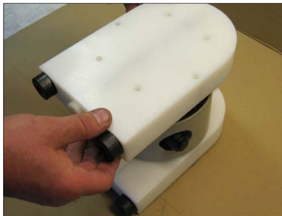
图23. 小心提起另一边的泵壳和带增压器 的不锈钢侧板。
