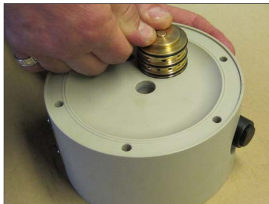
图2. 放一点水在o形环(30)上,不应使用其他润滑剂。 慢慢地把空气阀(61)压入泵壳。 卸载在其余侧的卡簧(27)(见图1)。
