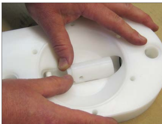
图16. 把挡套(19)颠倒并朝上阀座(20)压进。
