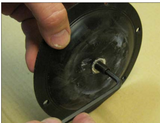
图11. 用内流扳手在隔膜(15)中牢固地安装 销螺钉(部分隔膜片轴pos 16)。
