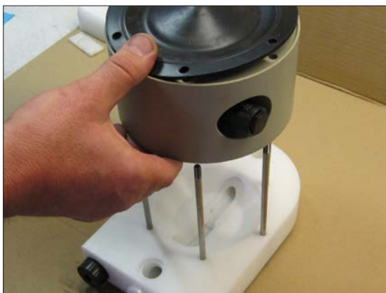
图20. 确保所有销螺丝(14)有一个螺母(37)和一个垫圈(38)。 螺母应该只有一个或两个线程。把销螺丝穿过泵壳 和不锈钢侧板和仔细组装中间体总成。
