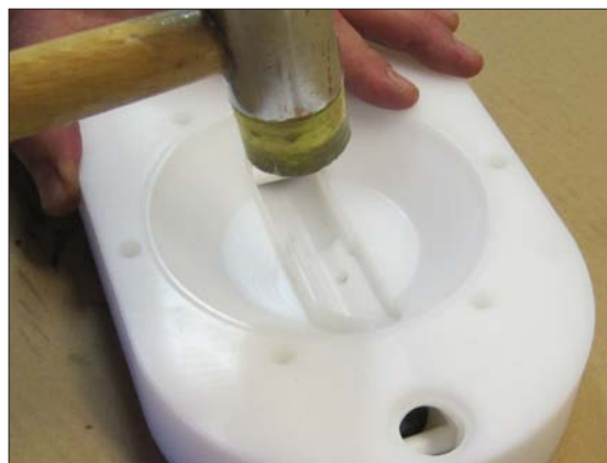
图18. 确保阀座和套筒总成在泵壳内平衡。
