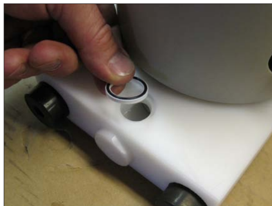
图21. 把小o形环(pos 18)放在泵壳座里。 PTFE封膜片泵的o形环u环， 应该将o形环朝上(见图21)。
