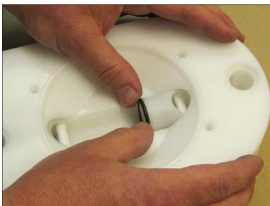
图15. 安装高位阀座总成;高位座位(20), 阀球(23),球挡(22)和O形环(43)。
