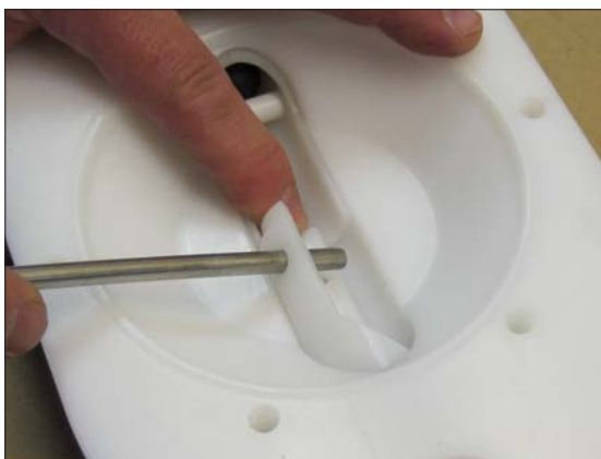
图17. 把其中一个销螺丝放进挡套(19)中,并轻轻地转动。 用塑料锤轻轻地敲击方便卸下挡套。
