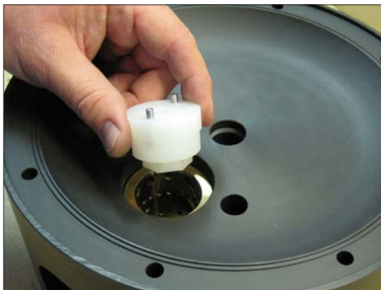
图15. 用气缸相应的安装工具的另一面推出气缸。
