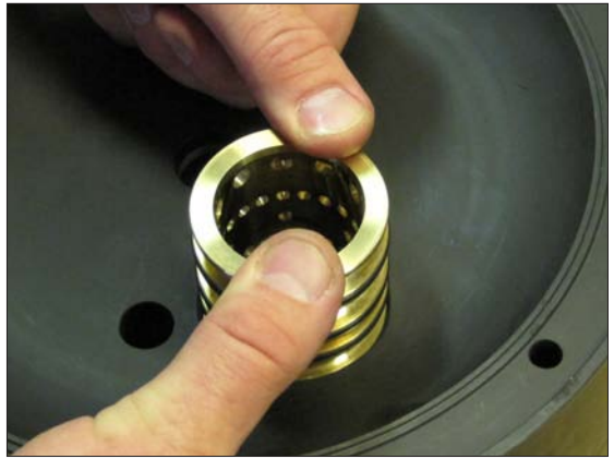
图6. 确保所有四个o型环(pos 30)安装在汽缸上。 用少量水滴在o形环上,润滑气缸进入中间 体-。不应使用其他润滑剂。
