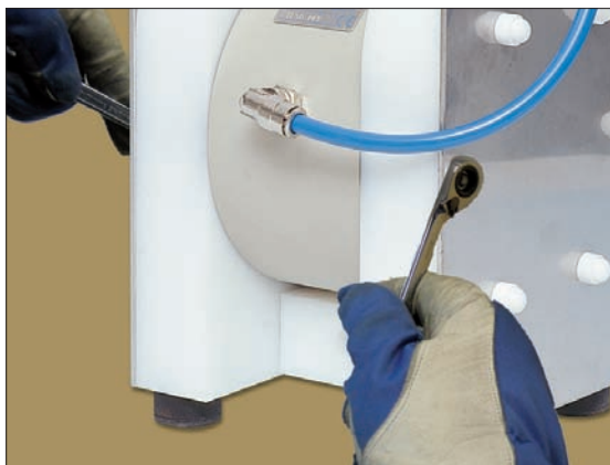
图22. 安装进口和出口处连接(13), 确保所有o形环(18)安装到位。
